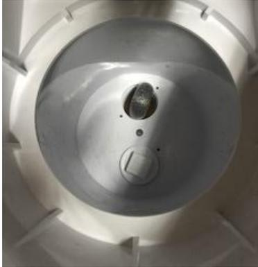
17. Couper une petite section du tube de mousse (2po sera suffisant) et la conserver pour une prochaine étape. Mettre le plus long des tubes de mousse (H.) au plus profond dans le trou du drain de fond et faire une boucle ou un nœud au bout pour que celui-ci reste accroché dans le trou du drain (étape assez difficile car la mousse a toujours tendance à remonter).
