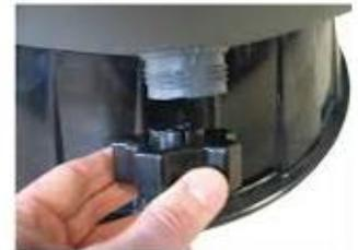
5. Enlever le bocal en verre (*et son joint*), le manomètre et les ranger dans un endroit avec une température positive.
