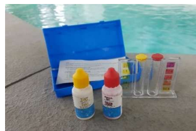
Exemple de kit de gouttes d'analyse pH et chlore
